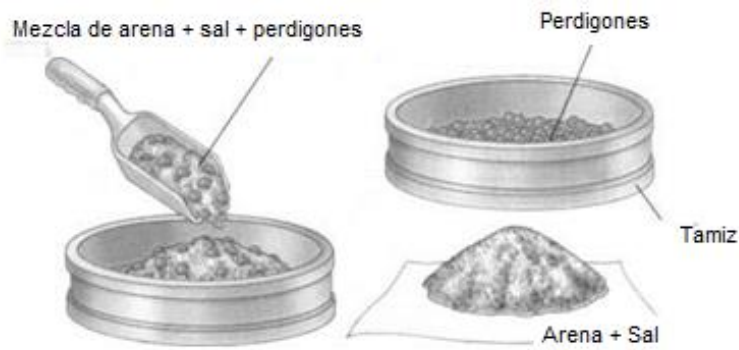
Fig. 14. Separación de perdigones de plomo, arena y sal.
